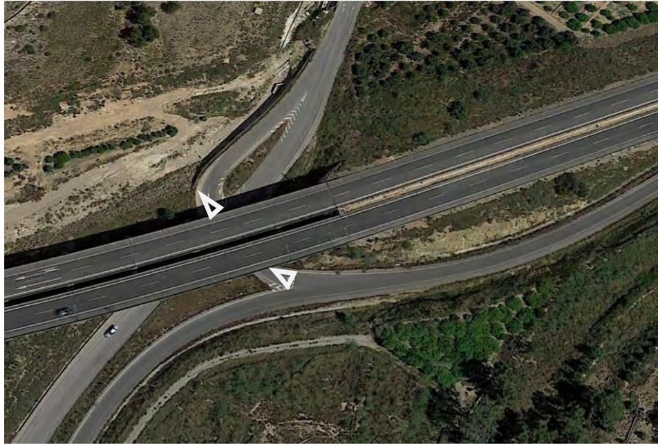
Existen dos intersecciones, la intersección 1 y la intersección 2 para acceder los vehículos provenientes de la RM-414 a la A-7 dirección Alicante que en el proyecto del tercer carril se sustituirá por una glorieta.
