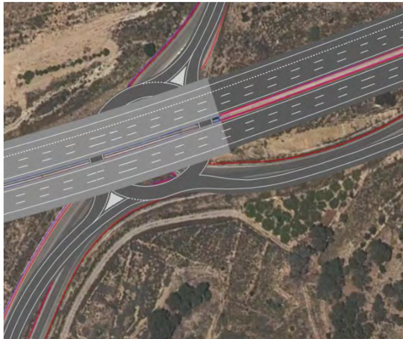
Diseño de modificación de doble intersección por glorieta para el acceso a la A-7 dirección Alicante
