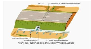
FIGURA 4.29.- EJEMPLO DE CUNETÓN DE REPARTO DE CAUDALES
