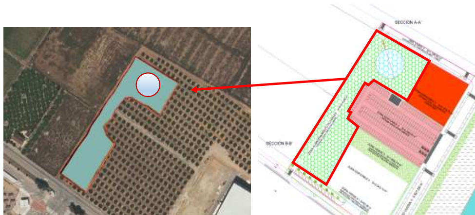
Modelo TIN de la superficie final obtenida para la ubicación del SUDS. En el centro, el sumidero. Como se puede comprobar, la superficie propuesta se corresponde con la zona verde reservada para el SUDS
